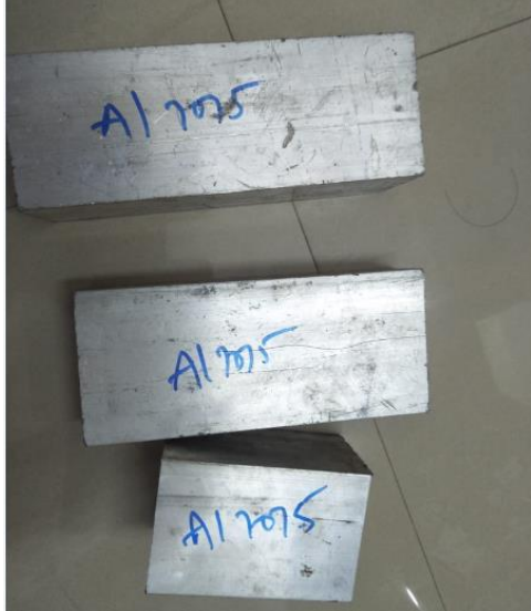
Fig: raw material of AL 7075
