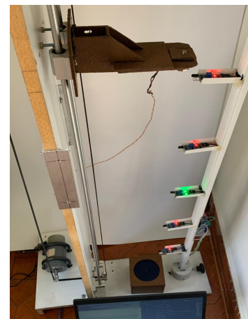
Fig 5. Montaje experimental para la planta remota de caída libre
